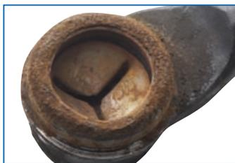
El diseño plástico no reparabile ha fallado a causa de la intrusión y el desgaste.
