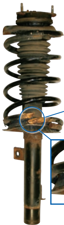
Resorte helicoidal de equipo original (OE) defectuoso
