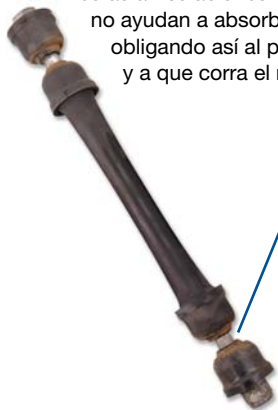
PEQUEÑO DIÁMETRO DEL PERNO ORIGINAL Sujeto a corrosión y a fallas prematuras
